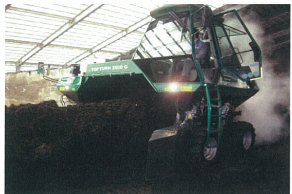
攪拌機稼働状況
